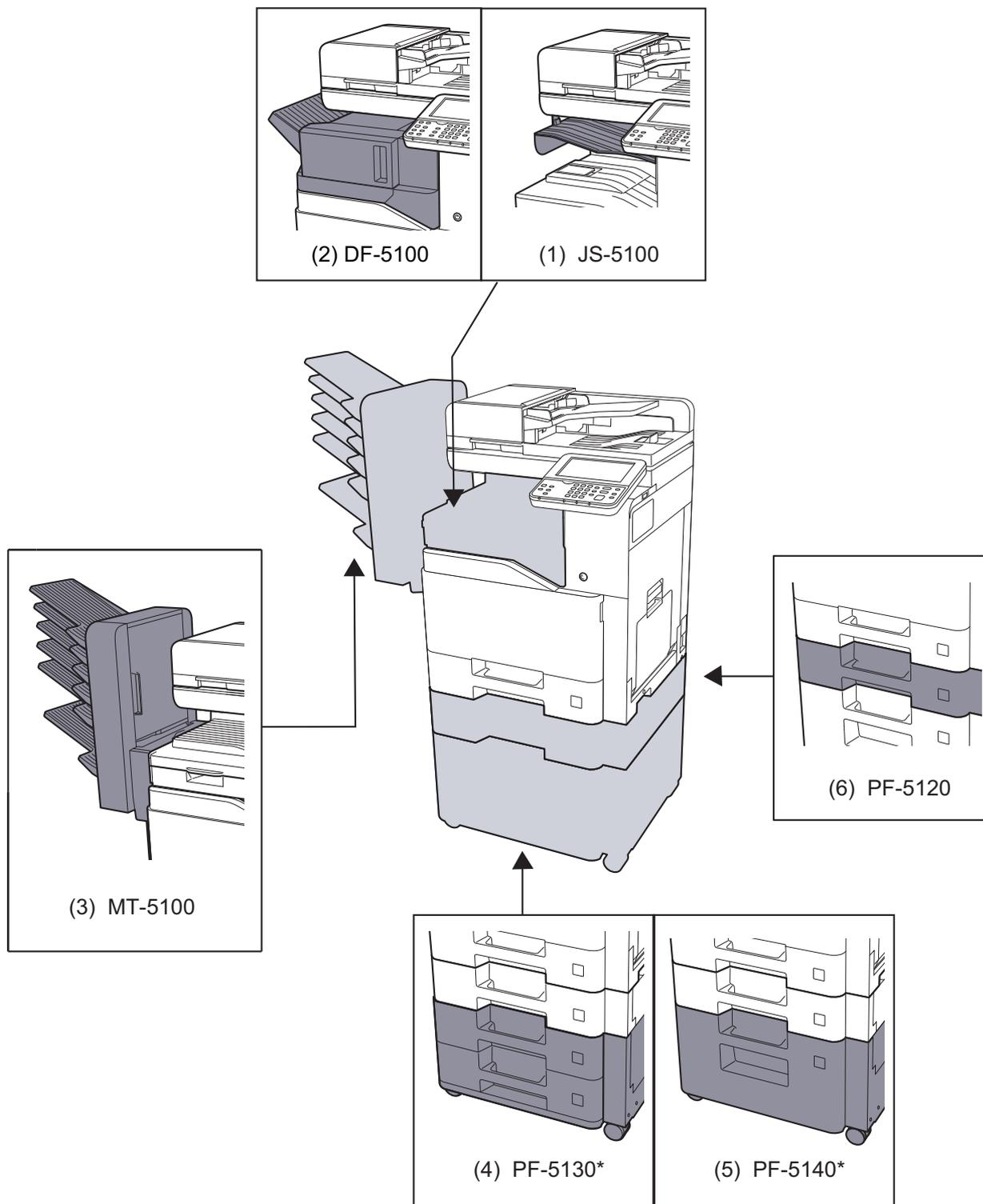
\* Se sul sistema è installato PF-5130 o PF-5140, occorre installare il kit anti-ribaltamento.
