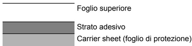
Come indicato in figura, le etichette sono composte da tre diversi strati. Lo strato adesivo contiene componenti molto sensibili alla forza applicata all'interno del sistema. Il carrier sheet supporta il foglio superiore fino a quando l'etichetta non viene utilizzata. Questa composizione di etichette potrebbe causare vari inconvenienti.
